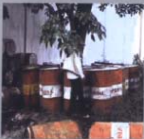
Gambar Pengelolaan Limbah B3 oli bekas yang tidak benar
